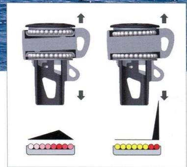
Der Lastverteiler schützt vor Punktbelastung einzelner Lagerkugeln!
