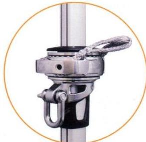
Der Fallschlitten der Furlex 104S bis 404S dreht sich auf einem Lager aus nicht rostendem Stahl. Die Zuglast des Falls wird über zwei Dyneema-Augen zentriert.
