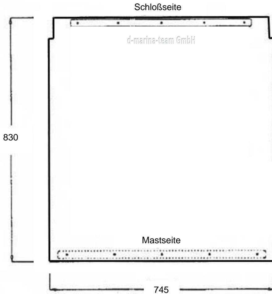
Die Bohrungen mit einem [Holzbohrer](#) erstellen
