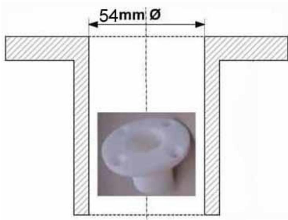
Nur bei einigen Schiffen wurden dünnwandige Buchsen eingesetzt. Lieferbar sind nur die verstärkten Buchsen, d.h. der Ausschnitt an Deck muss ca.1mm vergrößert werden.
