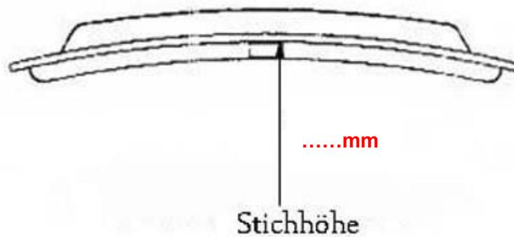
Griffleiste oben am Einstieg länge:.....mm D=.....mm H:.....mm
