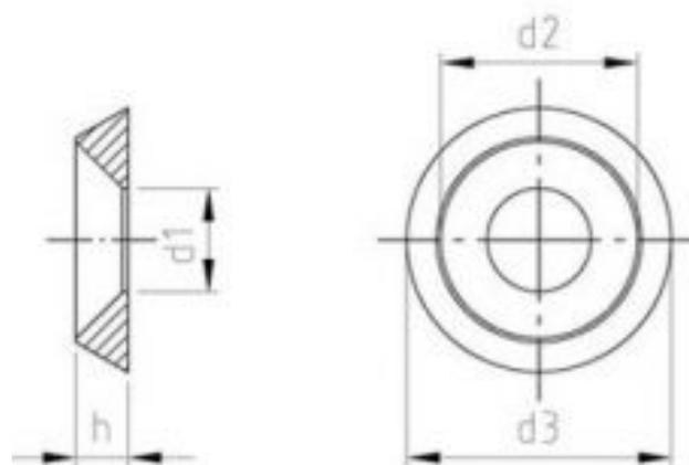
d1: 8,3mm; d2: 15,5mm; d3: 18mm; h: 4,5mm
