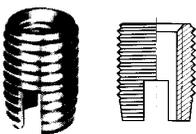
[Gewindemuffen M-Gewinde im Gfk erstellen](#)
