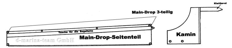
Nr. 20586 <u>Abdeckung über dem Reißverschluß</u> der Main-Drop-Persenning, zusätzlich Bestellen, Bei Bestellung Main-Drop wird RV-Abdeckung an einer Seite angenäht, die andere Seite wird mit Klett-/Haftband befestigt. Bei nachträglicher Bestellung ( beide Seiten mit Klettband.)
