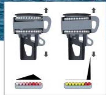
Der Lastverteiler schützt vor Punktbelastung einzelner Lagerkugeln!
