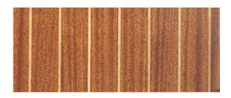
Aderabstand 40:4:40 mm etc., Innenlagen aus Okoumé, Rückseite Messerfurnier, Verleimung AW 100. Verwendungsbereich: Fußbodenbelag, Bootsinnenausbau.
