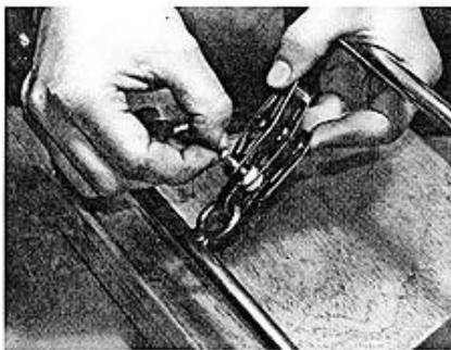
Block mit Hundsfot am Niro-Auge befestigen
