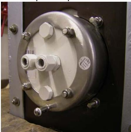
Neue Steuerpumpe, Ritzelseite mit Pumpen- + Konus-Adapter
