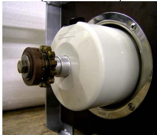
Die neue Steuerpumpe [Nr. 11843](#) hat einen geringeren Durchmesser als die Original-Steuerpumpe und hat keinen Anbaufansch. Desweiteren ist der Konus der Pumpenachse an der neuen Pumpe nicht mehr 25:19mm, sondern 19:17mm, wodurch das Kettenritzel auch nicht mehr passt.
