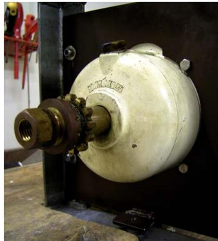
Neue Steuerpumpe, Anschlussseite mit Pumpenadapter
