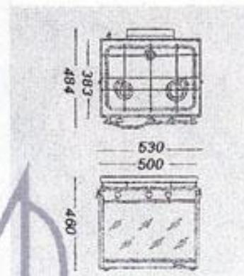
**Technische Daten:** Leistung: Brenner groß: 2,3 kW, Mittel: 1,7 kW, Klein: 1,0 kW, Ofen: 1,7 kW, Gewicht: 21 kg, Backofenvolumen: 900 cm<sup>3</sup>. *Durch den Einsatz von 2 Backblechen erzielt man eine optimale Wärmeverteilung im Backofen!*
