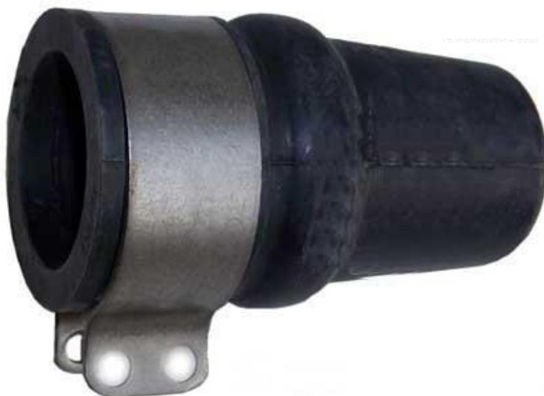
Die Propellerwellendichtung ist nur für den Einbau unter der Wasserlinie vorgesehen, da sie mit Wasser geschmiert wird. Prüfen, dass die Wassereinflüsse für die Lagerschmierung der Propellerwelle richtig ausgeführt sind, um sicherzustellen, dass die Propellerwellendichtung während des Betriebes mit Wasser versorgt wird.
